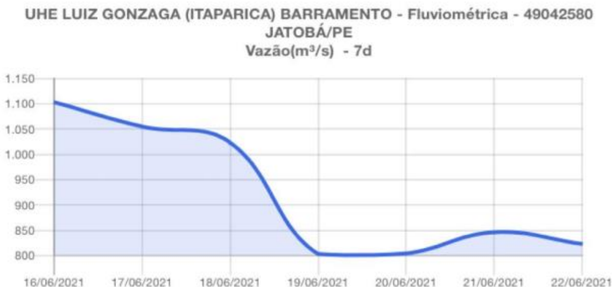
Figura 375 – Vazão Rio São Francisco no período de 7 dias Fonte: ANA - HIDROWEB MOBILE, 2021.
