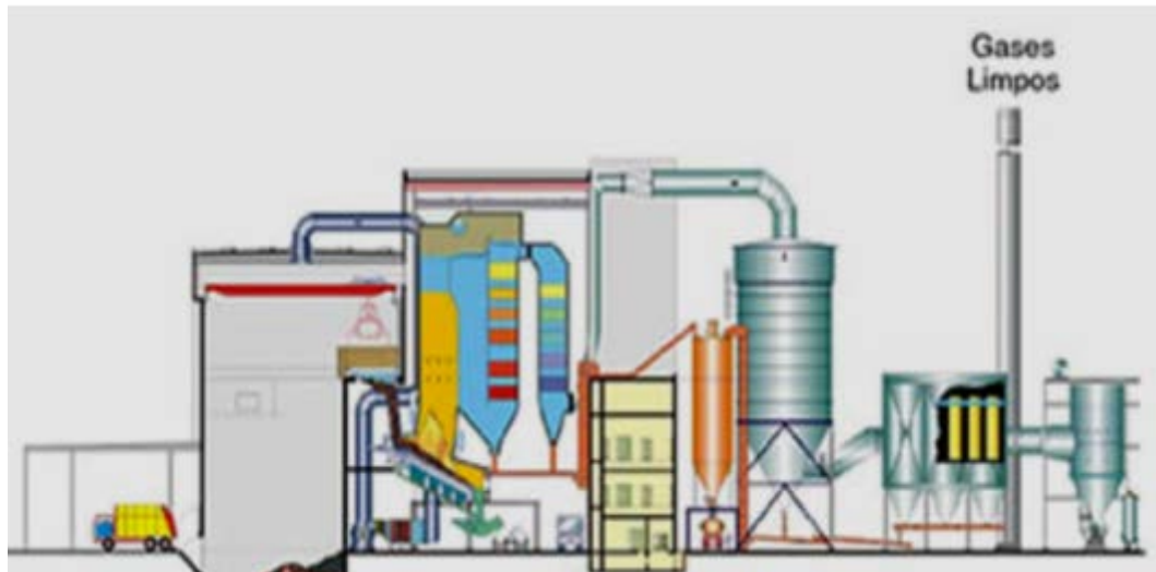
Figura 255– Esquema de Incineração para Geração de Energia Fonte: SÃO PAULO, 2017.
