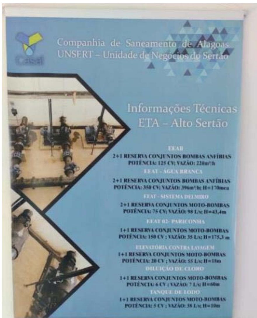
Figura 26 – Informações Técnicas ETA-Alto Sertão
